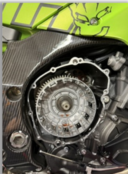
2 - Retirer tous les disques d'embrayage et dévisser la cloche.
