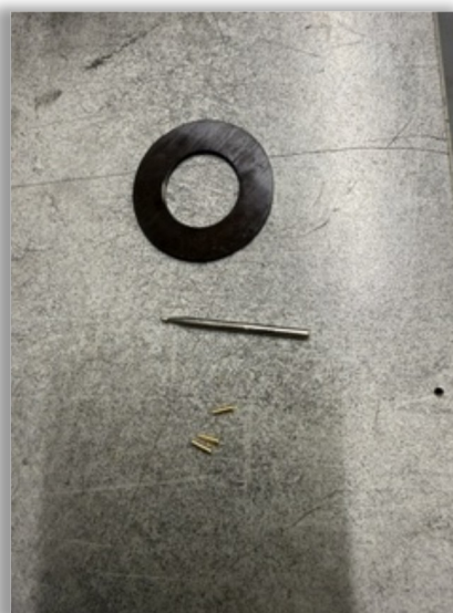
4 - Équipez-vous de l'outil type Dremel fourni pour agrandir le trou de lubrification de l'arbre d'embrayage afin de pouvoir le boucher par la suite avec la pointe en laiton fournie.
