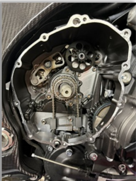
3 - Retirer le canon pour être au même point que sur la photo.
